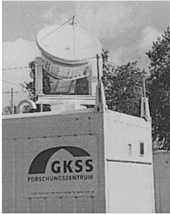
FIG. 1. The GKSS 95-GHz polarimetric cloud radar.
